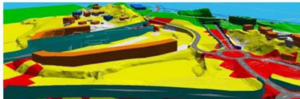
Figur 4-4: 3D-utsnitt fra støyberegningssmodellen. Fremtidig situasjon med ny E39, inkludert eksempel på skjermingstiltak. Nord er til venstre i figuren.
